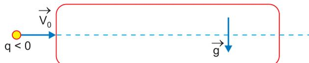
O campo de indução magnética no interior da câmara, perpendicular ao plano da figura, não está representado. Somente íons com determinada razão massa/carga, ou  $\frac{m}{|q|}$ , descrevem a trajetória retilínea mostrada na figura, passando por pequenas aberturas alinhadas na câmara.
