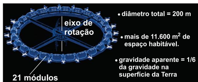
A gravidade aparente sentida nos módulos apresentados na imagem é resultado do giro da estação espacial em torno do eixo de rotação.
