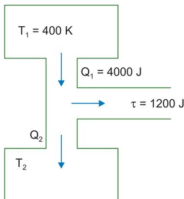
Seu rendimento corresponde a 75% do rendimento da máquina de Carnot, em regime de funcionamento entre as temperaturas  $T_1$  e  $T_2$ . Nessas condições, a temperatura  $T_2$ , da fonte fria, é, em kelvin,
