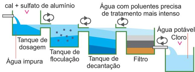
O processo normal de tratamento da água inclui filtrar, decantar e colocar cloro, cal, sulfato de alumínio e flúor.
