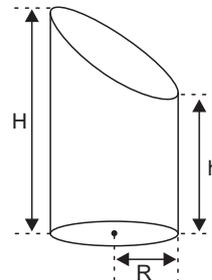
A montagem desse suporte é feita a partir de cilindros retos que são cortados. O projetista dessa empresa faz o esboço desse suporte em um programa de computação paramétrica para detalhar as medidas resultantes após a realização do corte na peça cilíndrica, baseado no seguinte esquema:
